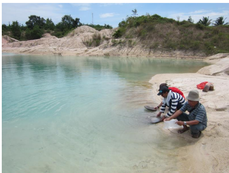
Gambar 2. Pengambilan sampel konsentrat dulang pada tailing tambang timah
