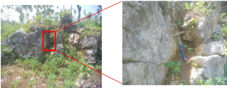
**Gambar 6.** Singkapan batuan litofasies grainstone pada STA 7
