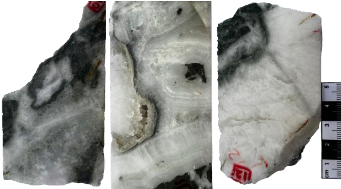
Gambar 10. Urat kuarsa±karbonat, dengan tekstur kristalin-mikrokristalin, dan minor crustiform/colloform banded dengan lapisan sulfida dan klorit berwarna kehijauan
