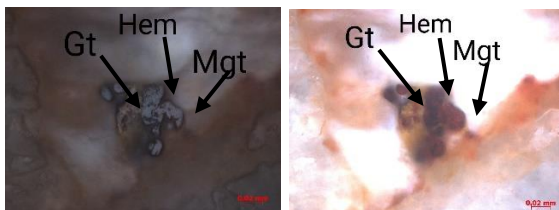
Gambar 11. Fotomikrograf sampel konkresi pisolitik (PP2), pengamatan nikol sejajar sampel (kiri) dan nikol silang (kanan). Keterangan: Hem = hematit, Gt = Goethit, dan Mgt = Magnetit
