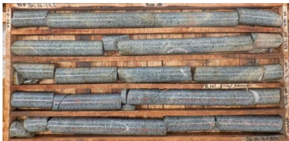
Gambar 9. Pada lubang bor nomor A_01, inti bor kedalaman 240,00 s.d 245,00 meter, memperlihatkan dasit porfiri, teralterasi sedang oleh klorit-epidot-kalsit, dan teralterasi lemah oleh silika, terdapat urat silika di kedalaman 241,65 meter, terdapat veinlet epidot dan kalsit, urat kuarsa-kalsit di kedalaman 244,40 meter, kalsit mengisi rekahan, sedikit hornblenda
