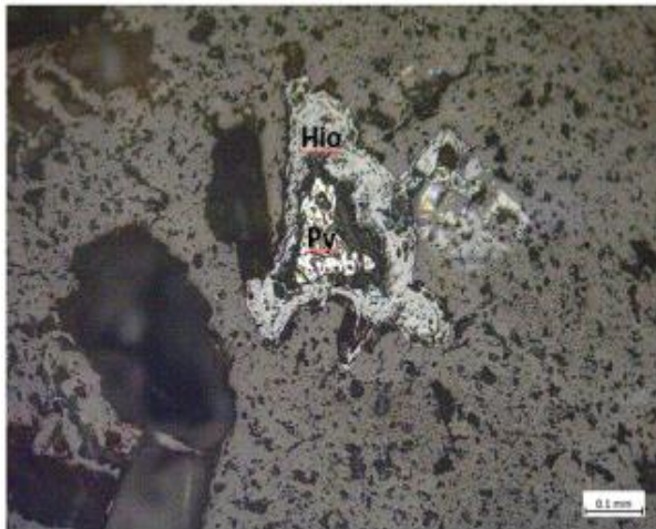
Gambar 27. Fotomikrograf sayatan poles sampel A3 a. Kenampakan PPL (kiri) dan XPL (kanan) pirit (Py) dikelilingi hidros besi oksida (Hio)
