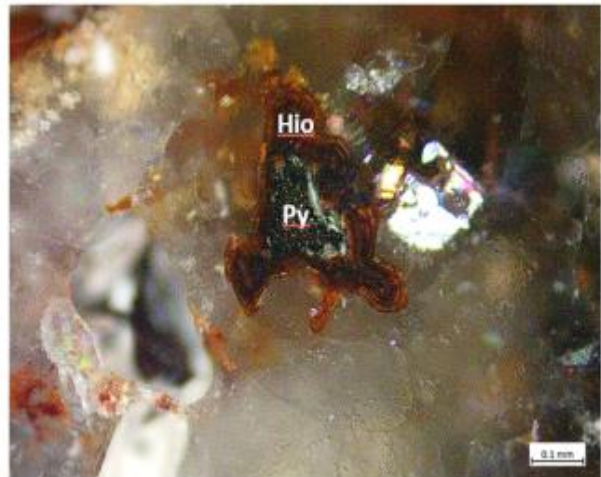
Gambar 27. Fotomikrograf sayatan poles sampel A3 a. Kenampakan PPL (kiri) dan XPL (kanan) pirit (Py) dikelilingi hidros besi oksida (Hio)
