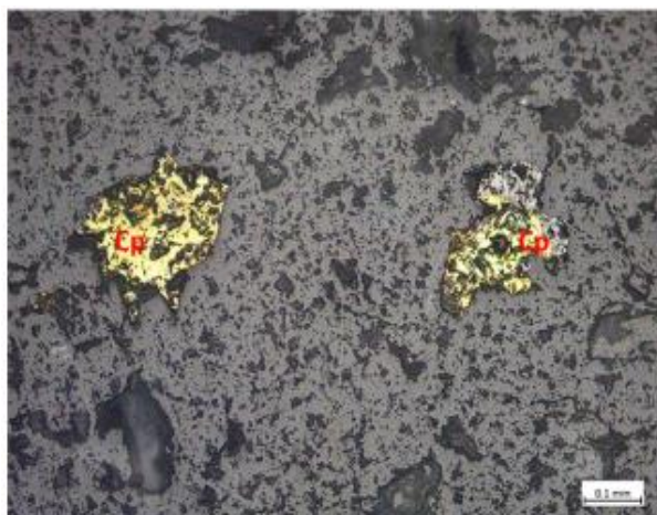
Gambar 31. Fotomikrograf sayatan poles sampel A3 b. Kenampakan PPL (kiri) dan XPL (kanan), mineral kalkopirit (Cp)
