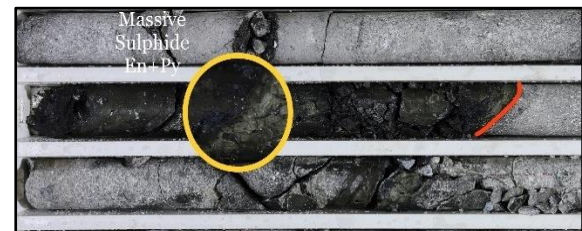
Gambar 25. Mineralisasi bijih sulfida berupa open space filling dan massive sulfide (GTD-785 ; kedalaman 265 meter)
