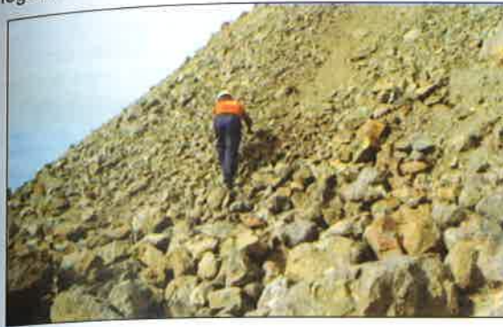
Gambar 5. Stock pile bijih emas Tambang Mesel mengandung Sulfida antimoni, merkuri dan arsen
