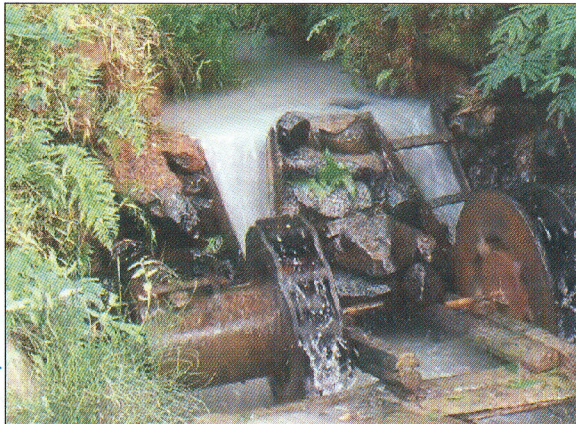
Gambar 2. Tromol untuk amalgamasi menggunakan tenaga air, Tasikmalaya
