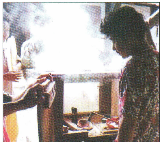
Gambar 5. Pembakaran amalgam, kepulan uap merkuri dibiarkan terbuang, Gorontalo
