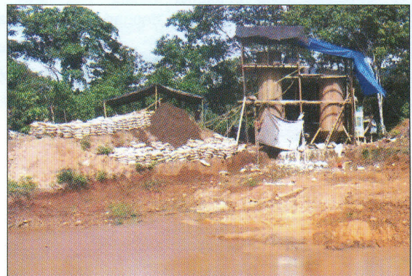
Gambar 4. Reaktor sianidasi, latar depan kolam tailing, Halmahera Utara
