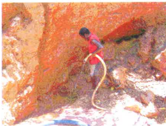
Gambar 3 Penyemprotan tanah residual yang dialirkan ke dalam sluice box untuk memperoleh mineral berat dan emas ( Lokasi : Tambang Bobi).
