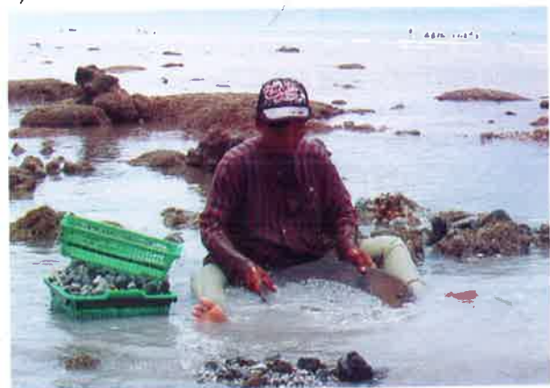
Gambar 5. Pendulangan pasir timah, dan penambangan menggunakan sekop (titik-titik kehitaman di kejauhan), lepas pantai timur Pulau Singkep
