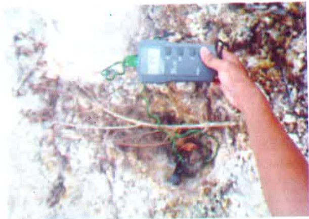
Gambar 9 Pengukuran temperatur manifestasi tanah panas "Karun"
