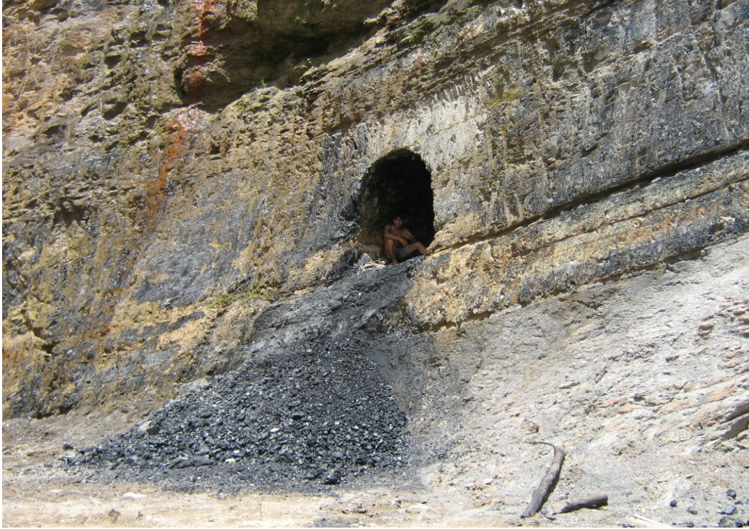
Foto.5 Penambangan batubara oleh rakyat, dengan membuat lubang horizontal searah jurus lapisan batubara (Koleksi : Dede Ibnu Suhada, 2006)
