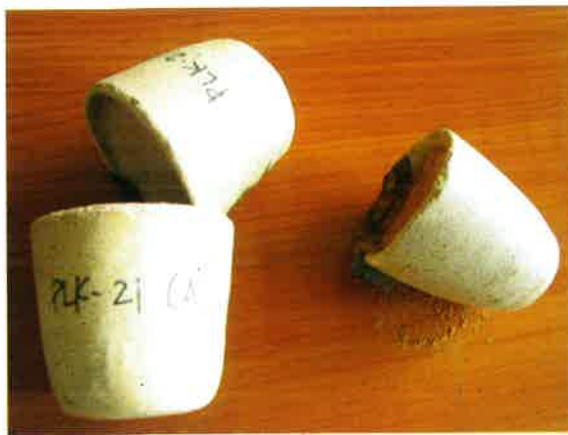
Gambar 2. Keramik hasil uji bakar lempung jenis kaolin (kiri), hasil uji bakar lempung jenis fireclay (kanan)
