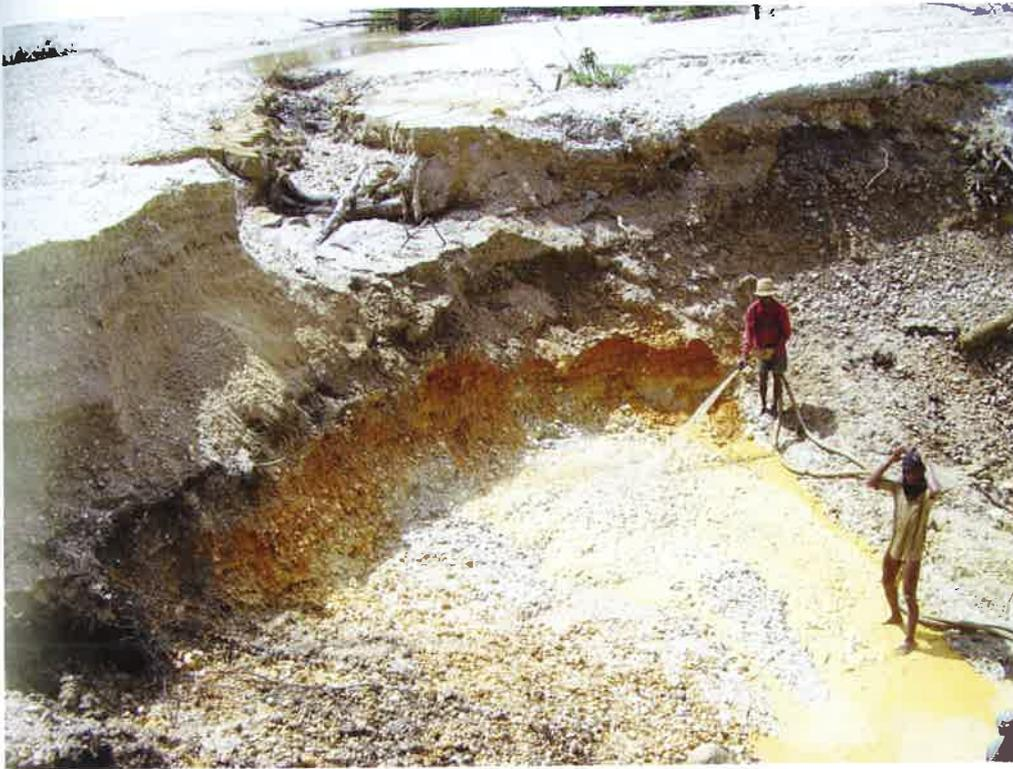
Foto 1. Kegiatan penambangan timah putih plaser di daerah P. Bangka yang mengandung mineral logam langka ( Sabtanto, 2006).
