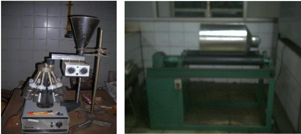
Gambar 13. Peralatan preparasi conto laterit nikel jenis Divider dan mesin pengaduk
