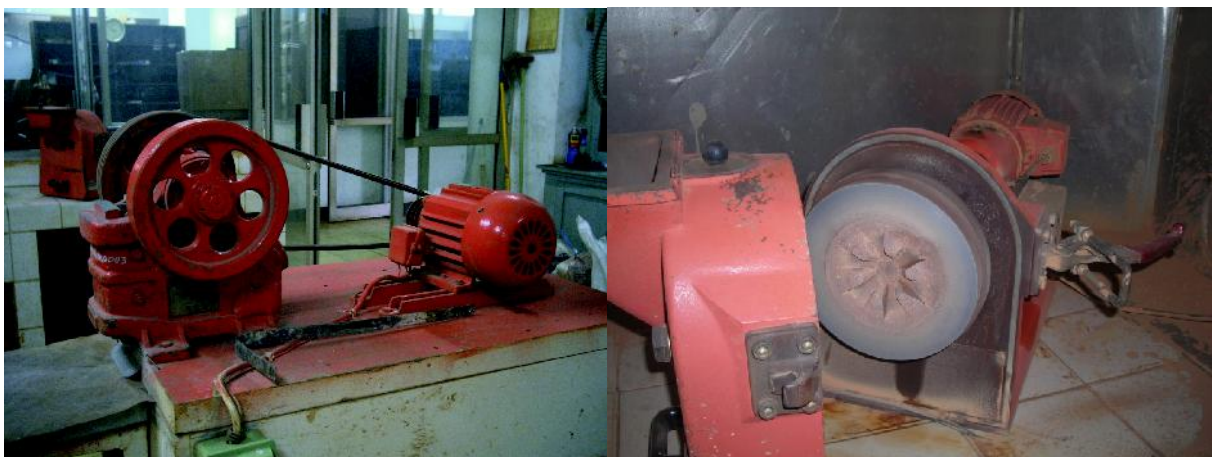
Gambar 12. Peralatan preparasi conto laterit nikel jenis Jaw Crusher dan Pulverizer
