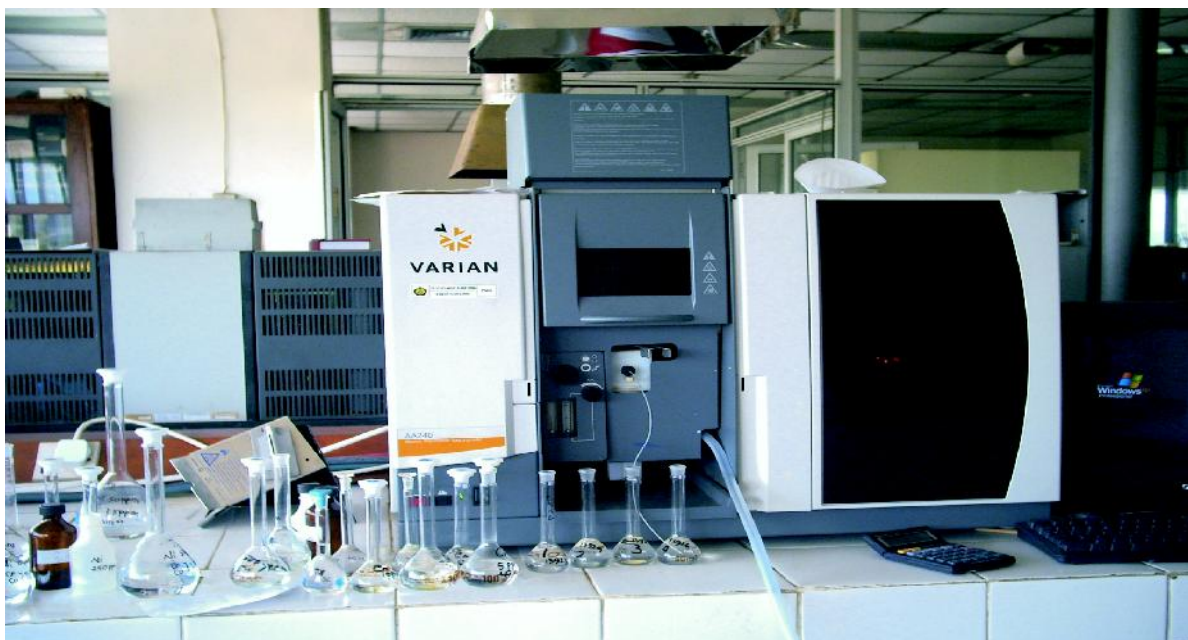
Gambar 14. Atomic Absorption Spectrometer (AAS) Varian Type AA 240 merupakan alat untuk analisis laterit nikel
