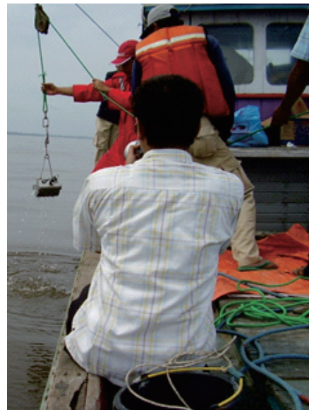
Gambar 4. Peralatan grab sampler untuk pengambilan pasir sedimen di dasar laut.
