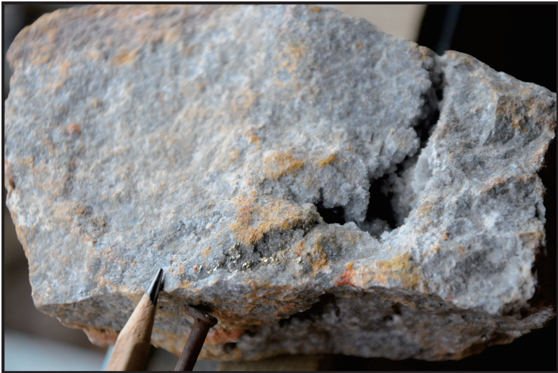
Batuan terkersikkan, berongga, mengandung kalkopirit dan pirit di Blok Tanggeung, Cianjur.
